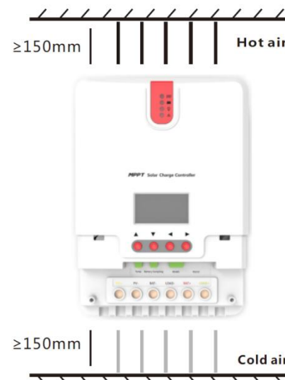
Рисунок 2-1. Установка и рассеивание тепла
